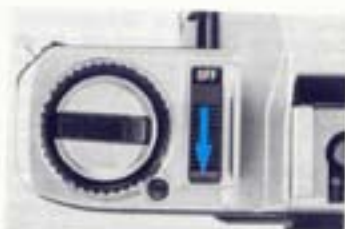
11. Hauptschalter auf OFF schieben (S. 22)
